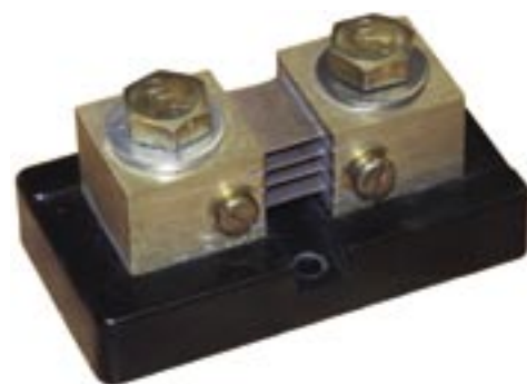
Ovan visas ett motstånd som kallas shunt. Man mäter spänningsfallet och gör om det till strömmätning i instrumentet. Motståndet är dock mycket mindre än i en gammal amperemätare av spoltyp som inte har shunt.
