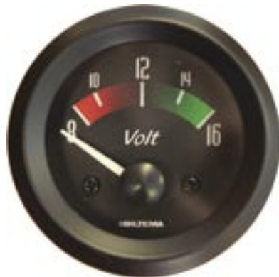
Ovan visas en vanligt förekommande typ av voltmeter som är för inexact för att vara en bra tankmätare för el. Ett digitalt instrument måste man ha där man kan läsa av tiondels volt.
