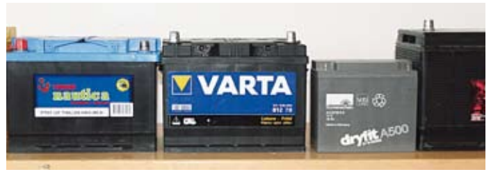
Bilden visar ganska lika batterier utom ett, det lilla (ett gelbatteri). För testen med 115 A generatorm använde vi ett mycket vanligt batteri, Tudor marinbatterier på 80 amperetimmar (Ah). Det är ganska bra på att släppa fram laddströmmen, ungefär som Vartas motsvarighet. Men en av batteriertyperna ovan är lite sämre på det. Om man använder gelbatterier måste man lägga på ett antal procent ytterligare vikt för att få samma laddresultat som vi fått (och mycket mer pengar). Hade vi använt spiralcellsbatterier som Optima batterier hade vi å andra sidan kunnat ta bort ett antal kg. Samtidigt hade vi dock blivit av med väldigt mycket mer pengar, varför man bör vara mycket intresserad av låg vikt för att det ska vara intressant.
